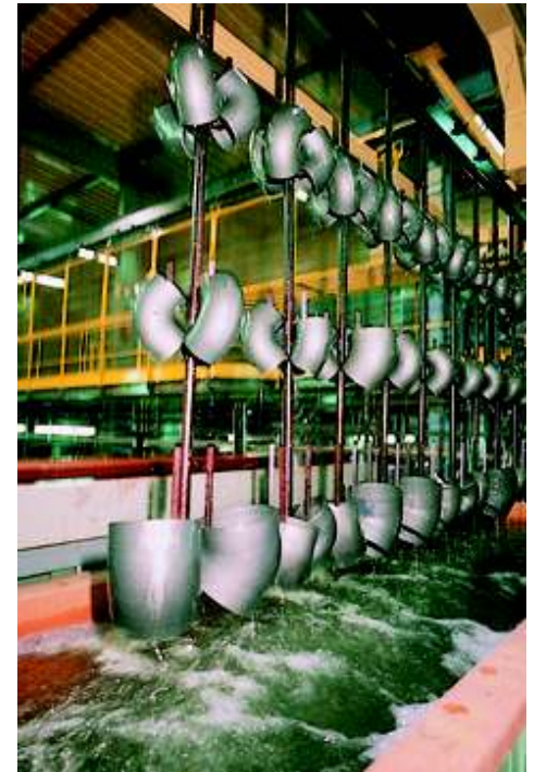
Vorbehandlung der PAM-GLOBAL® Formstücke im KTL-Beschichtungsverfahren
